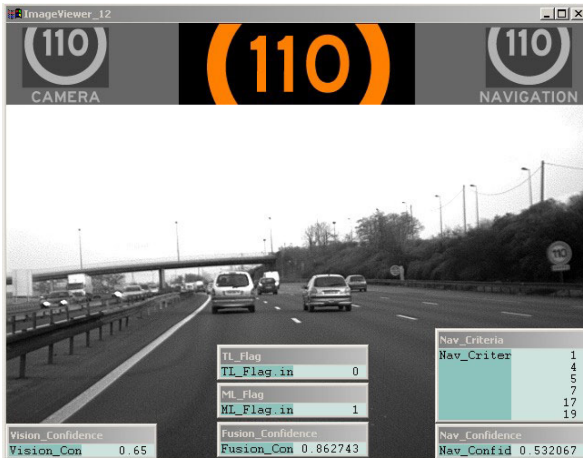
Figure 5-38 : Résultats de simulation HIL du capteur de détermination de situations de conduite – Conduite en autoroute
