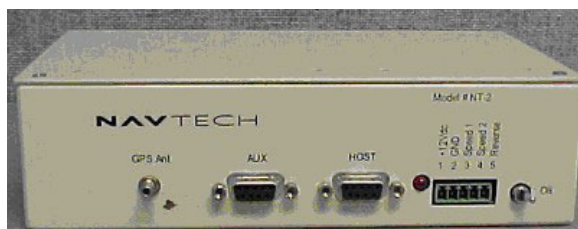
Figure 5-6 : Centrale de mesure SensorBox d'ADASRP (Extrait de [59])
