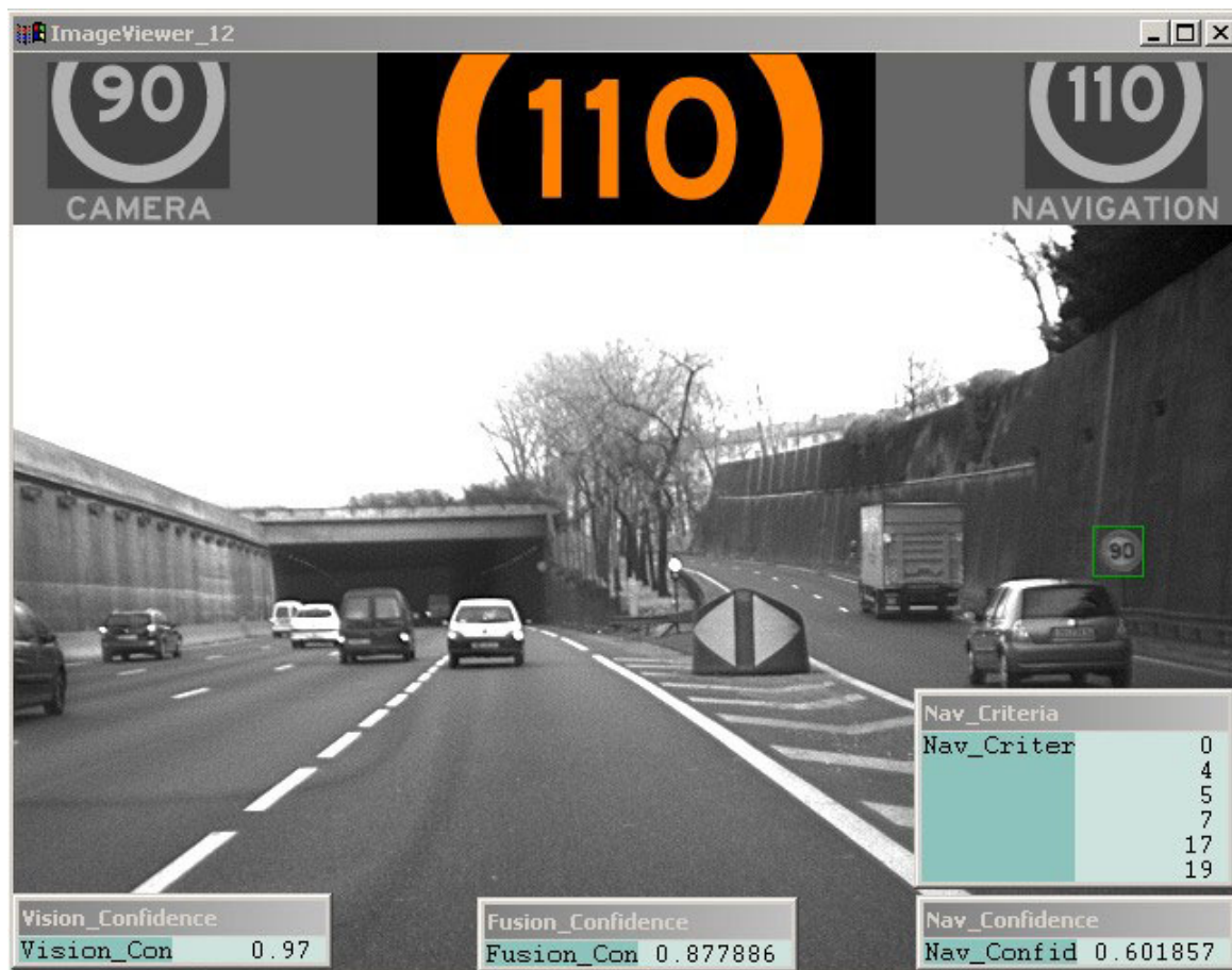
Figure 5-53 : Résultats du système SLS en sortie d'autoroute
