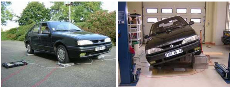
Fig. 3.26 Mesure de la masse et de la position du centre de gravité
