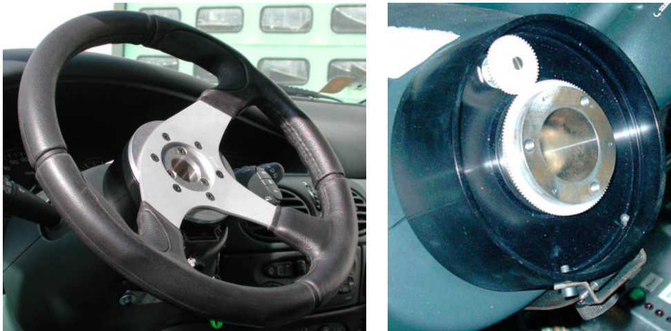
FIG. 6.4. : Dispositif de mesure de l'angle de braquage
