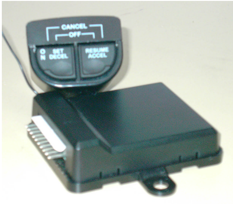
FIG. 4.1. : Télécommande & récepteur HF du véhicule NADINE
