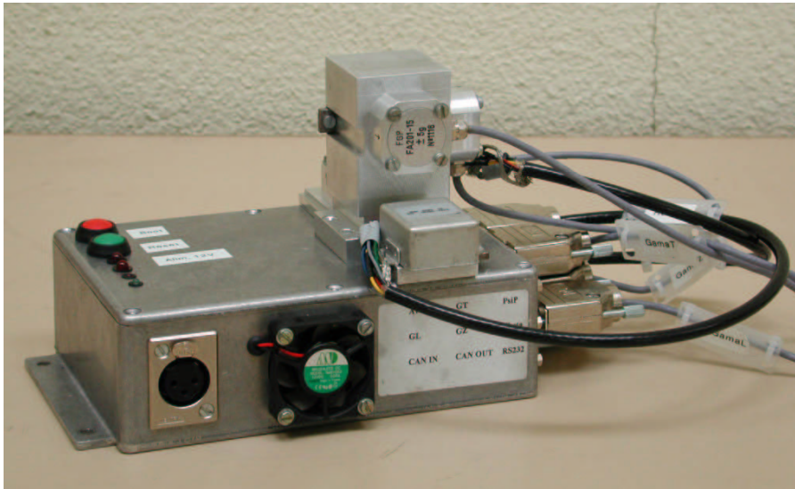
FIG. 6.3. : Centrale inertielle du véhicule NADINE
